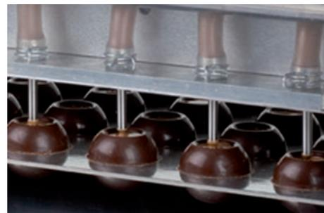
El ajuste de la presión del recipiente (0-1 bar) y el tiempo de apertura controla de forma precisa la cantidad de relleno dispensado.
