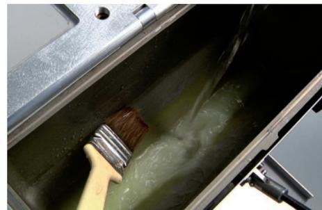
**La posibilidad de inclinación de 90°** del recipiente facilita los procesos de limpieza y mantenimiento.
